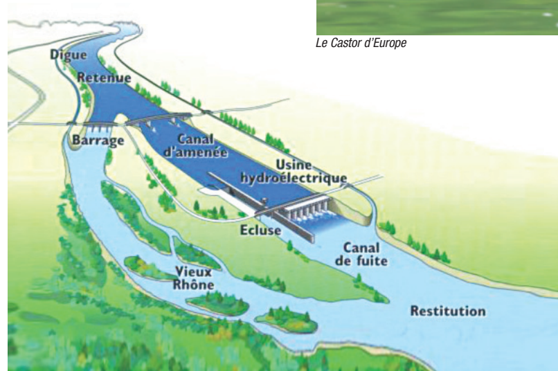
Schéma type d'une portion du Rhône aménagée par la Compagnie Nationale du Rhône (CNR)
